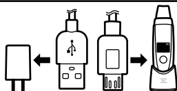
1. 充電ケーブルの接続
